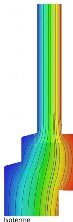
NOTE: Calcolato come da UNI EN ISO 12567-1:2010 (Finestra 1 anta 1230x1480 mm). (Portafinestra 1 anta 1480x2180mm).  $U_g = 0,6 \text{ W/m}^2\text{K}$  e  $U_{f,g} = 0,04 \text{ Wm}^2\text{K}$ . Dati di progetto: temperatura esterna di  $0^\circ\text{C}$  temperatura interna di  $20^\circ\text{C}$  e 65% di umidità.
